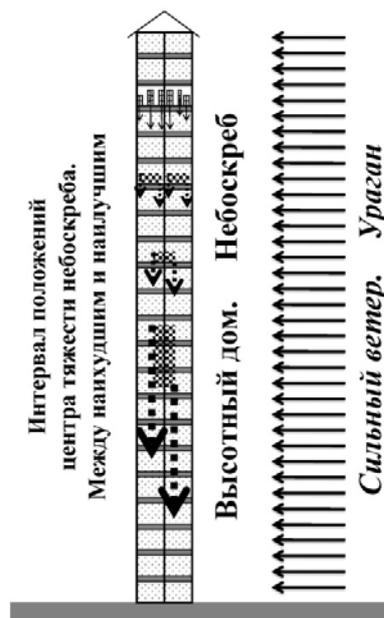
Рис. 1. Интервал положений центра тяжести небоскреба.
